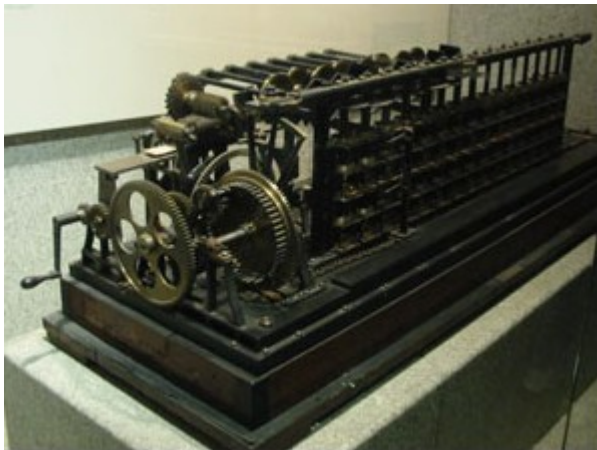
Scheutzov stroj - modifikácia Difference Engine
