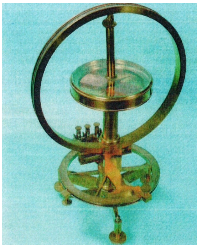
Priklady konštrukcie galvanometra z roku 1853. Používali už veľké množstvo závitov, slúžiacich ako tzv. multiplikátor.
