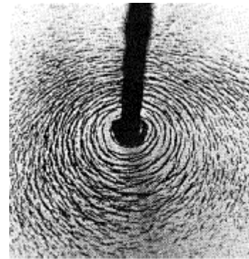
Pilinový obrazec magnetického poľa v okolí priameho vodiča s prúdom
